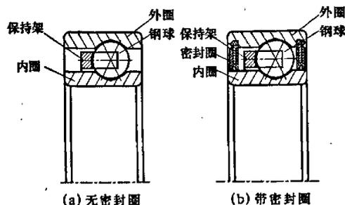
图1 薄壁四点接触球轴承
